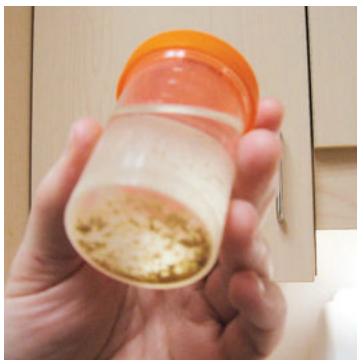
Figure 85 - Contamination de l'eau dans un hôpital Source : CMMTQ.
